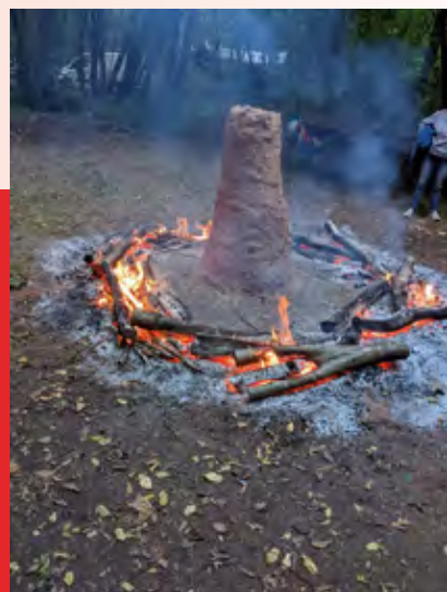
Degourdi - bassinage préparation du bas fourneau.
